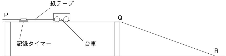
この実験装置の PQ は水平面，QR は斜面であり，台車にはたらく摩擦力や空気の抵抗は無視でき，台車は水平面と斜面が接する部分をなめらかに通過するものとする。
